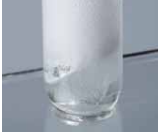
يتفاعل المغنيسيوم مع الحمض الهيدروكلوريك.
