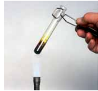
عند تسخين الحديد والكبريت، ترتبط ذرات الحديد وذرات الكبريت معاً لتكوين مركب كبريتيد الحديد.
