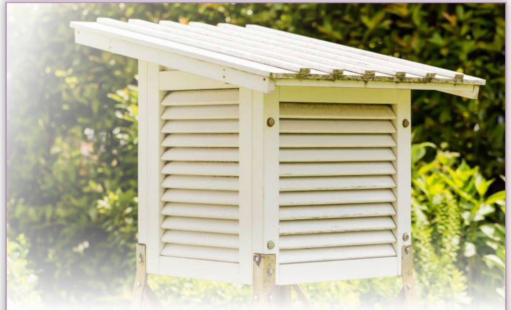
الشكل (11): كشك الرصد الجوي. أنتياً: ما سبب وجود فتحات جانبية مائلة في كشك الرصد الجوي؟
