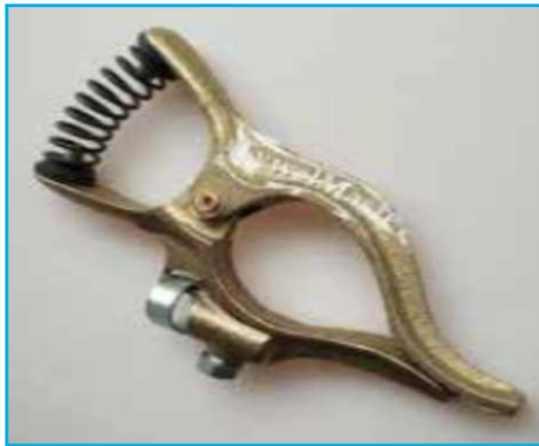
الشكل (19-7): مربوط كبل أرضي لماكينة لحام بالقوس الكهربائي.
