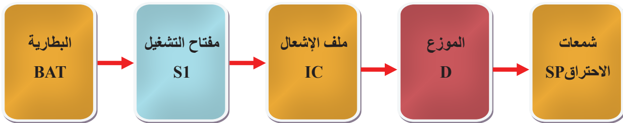
الشكل (5-4): المخطط الصندوقي لنظام الإشعال التقليدي.
