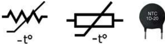
الشكل (42-4): ثيرمستور من نوع (NTC)، ورمزه.
