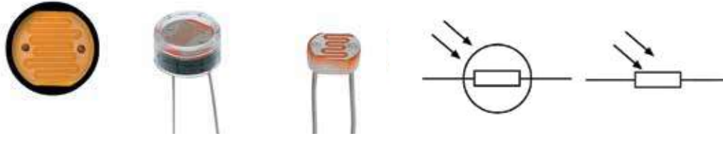
الشكل (4-7): المقاومة الضوئية (الرمز، والشكل العملي).
