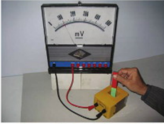
الشكل (4) تنشأ قوة محرّكة متحرّضة من تحريك مغناطيس داخل الوشّعة
