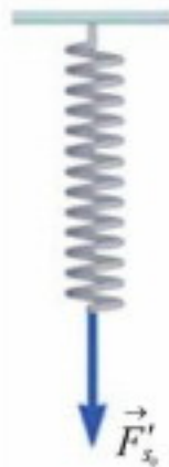
الشكل (4) القوة التي يؤثر فيها الجسم في النابض
