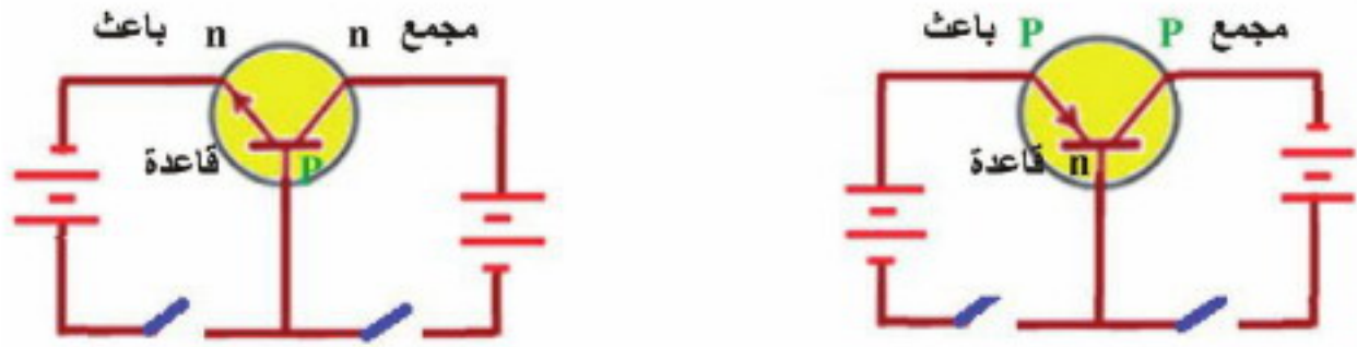
الشكل (14) طريقة التوصيل بالقاعدة المشتركة في الترانزستور
