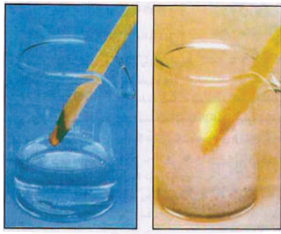
عدم توهج عود الثقاب بغيا ب الوسيط تأثير الوسيط MnO 2 على تفاعل تفكك الماء الأكسجيني توهج عود الثقاب بوجود الوسيط MnO 2 تأثير الوسيط MnO 2 على تفاعل تفكك الماء الأكسجيني
