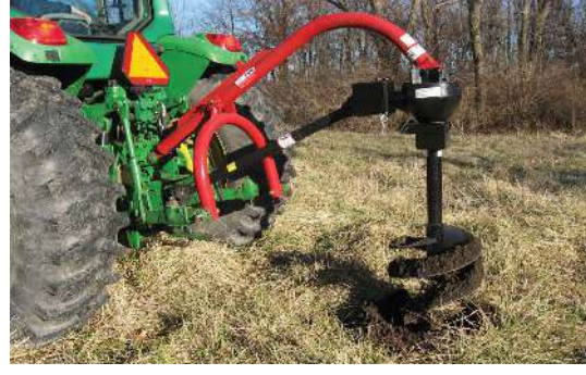
حفار يعمل بقوة الجرار
