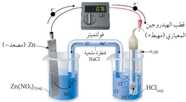
الشكل (7): خلية جلفانية قطباها الخارصين والهيدروجين المعياريان.
