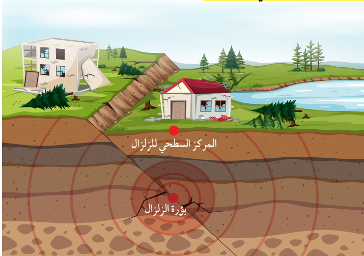
الشكل (1): بؤرة الزلزال، والمركز السطحي الذي يقع مباشرة فوقها على سطح الأرض.
