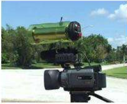
يقيس الرادار السرعة اللحظية للسيارة
