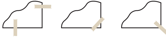
الشكل (1/10-ب): اللصق غير الصحيح لورقة الرسم.
