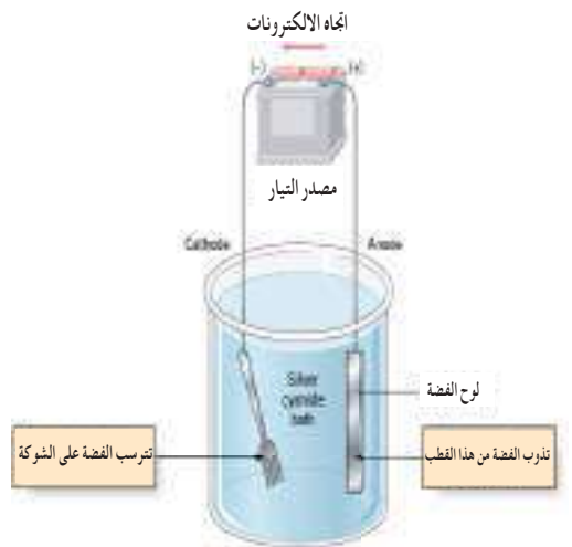
الشكل 4-8 خلية الطلاء الكهربائي
