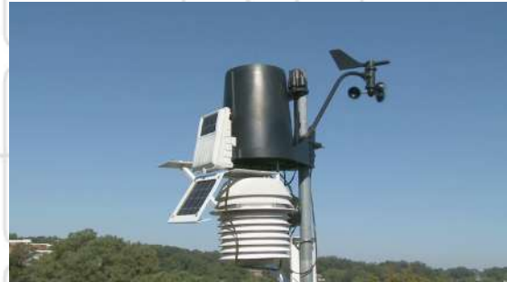
جهاز استشعار الأرصاد الجوية ويضم مقياساً للرياح ومقياس مطر ومقياس حرارة
