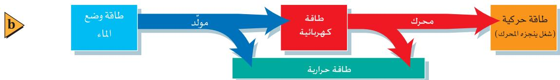
■ **الشكل 2-2** تتحول طاقة وضع ماء الشلال في النهاية إلى شغل مبذول على الدلو (a). ولا تصل كفاءة توليد التيار الكهربائي واستعماله إلى نسبة 100%؛ إذ تنتج بعض الطاقة الحرارية من خلال رش الماء والاحتكاك والمقاومة الكهربائية (b).
