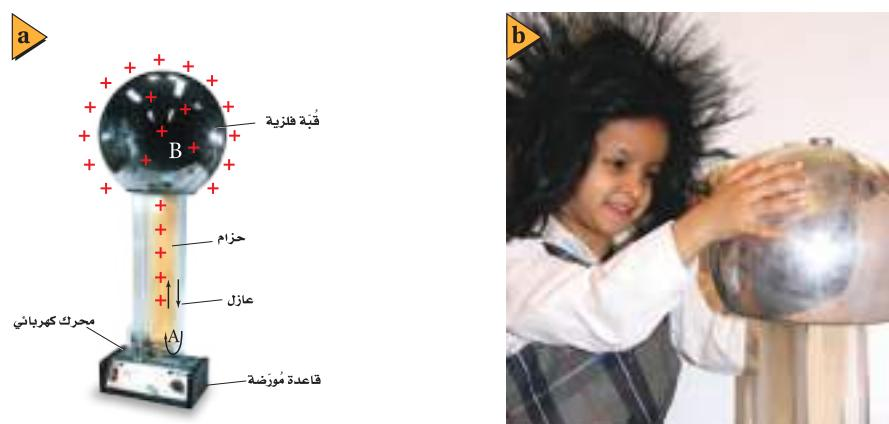
■ **الشكل 1-6** في مولد فان دي جراف (a)، تنتقل الشحنات إلى الحزام المتحرك عند النقطة A، ثم تنتقل من الحزام المتحرك إلى القبة الفلزية عند B. ويبذل المحرك الكهربائي الشغل اللازم لزيادة فرق الجهد الكهربائي. وعندما يلمس شخص معزول قبة مولد فان دي جراف تكون النتائج مثيرة (b).
