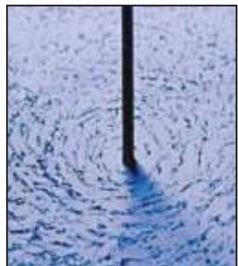
الشكل 10-4 يعكس اتجاه المجال المغناطيسي الناتج عن مرور تيار خلال سلك موصل مستقيم عندما يعكس اتجاه التيار المار به (a). ويحدد اتجاه المجال المغناطيسي الناتج عن سلك مستقيم يحمل تياراً باستخدام قاعدة قبضة اليد اليمنى (b).
