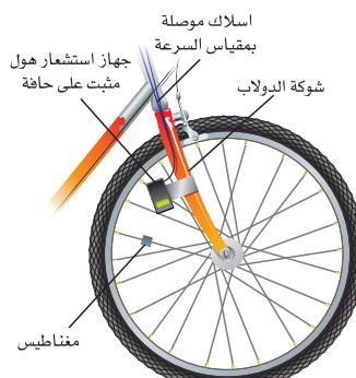
يستخدم المجس الذي يعمل وفق تأثير هول في مقياس سرعة الدراجة الهوائية لتحديد سرعتها
