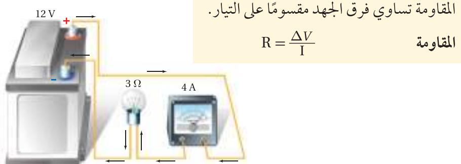
الشكل 5-2 يُعرف الأوم الواحد ( $1\Omega$ ) بأنه  $1\frac{V}{A}$ ، يمر تيار كهربائي مقداره  $1A$  في دائرة كهربائية تحتوي مقاومة كهربائية مقدارها  $1\Omega$  عند وصلها ببطارية، فرق الجهد بين قطبيها يساوي  $12V$ .
