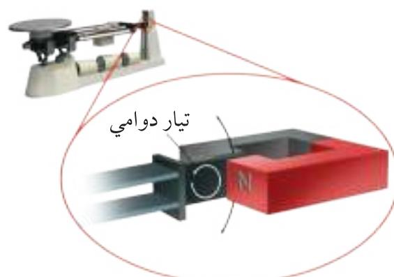
■ **الشكل 10-5** تستخدم الموازين الحساسة التيارات الدوامية المخادمة للتحكم في تأرجح مؤشر الميزان (a). فعندما تتحرك صفيحة الفلز المثبتة في نهاية المؤشر داخل المجال المغناطيسي يتوليد فيها تيار كهربائي. هذا التيار بدوره يولّد مجالاً مغناطيسياً يمانع الحركة المسببة له، لذا تصبح حركة المؤشر متخادمة (b).
