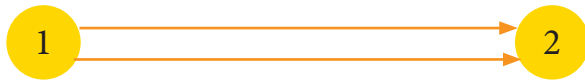
الشكل (3-5): بداية أكثر من نشاط واحد، يبدأ بحدث واحد، وينتهي بحدث واحد.
