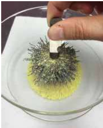
فصلُ بُرادةِ الحديدِ عن عنصِرِ الكبريتِ باستخدامِ المِغناطيسِ.
