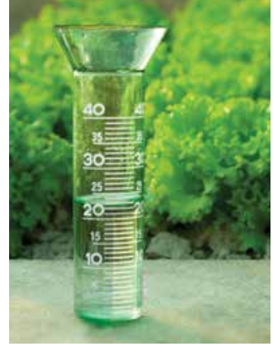
الشكل (3): جهاز مقياس المطر.
