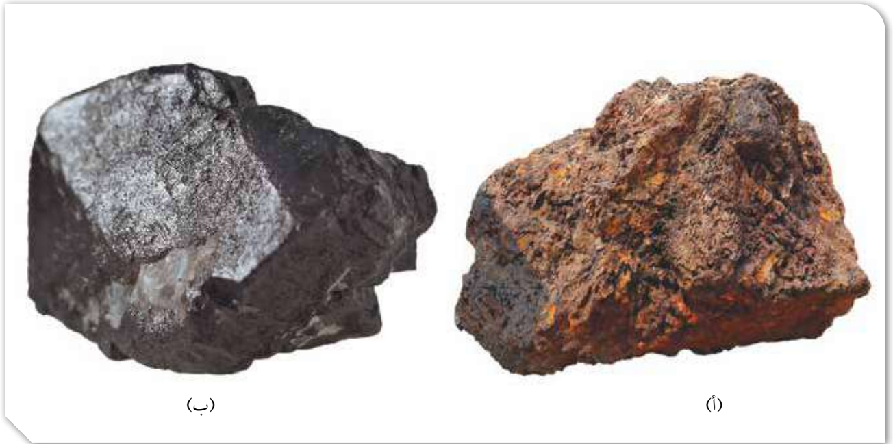
الشكل (22): من الأمثلة على معادن مجموعة الأكاسيد التي تُعدُّ إحدى خامات الحديد: (أ): الهيماتيت. (ب): الماغنتيت.
