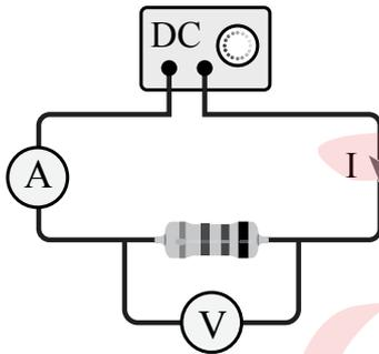
1. أصل الدارة الكهربائية كما في الشكل، بحيث يتصل طرفا المقاومة مع طرفي مصدر فرق الجهد، وقيس الأميتر (A) التيار المار في المقاومة، بينما يقيس الفولتميتر (V) فرق الجهد بين طرفيها.
