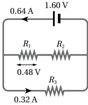
5. دائرة تتكون من بطارية مقاومتها الداخلية مهملة، تتصل مع ثلاث مقاومات ( $R_1, R_2, R_3$ )، كما هو مبين في الشكل. معتمداً على القيم المثبتة في الشكل؛ فإن مقدار المقاومة ( $R_2$ ) يساوي:
