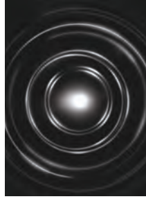
■ الشكل 1-9 تُظهر أنماط حيود الإلكترونات - كهذا النمط الخاص ببلورة زركونيوم مكعبة - الخصائص الموجية للجسيمات.
