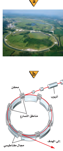
■ الشكل 11-3 سنكروترون مختبر فيرمي نصف قطره 2 km (a). السنكروترون عبارة عن مسارع دائري، تستخدم فيه المغناطيس لضبط المسار وتسارع الجسيمات (b).
