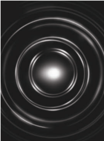
الشكل 9-1 تُظهر أنماط حيود الإلكترونات - كهذا النمط الخاص ببلورة زركونيوم مكعبة - الخصائص الموجية للجسيمات.
