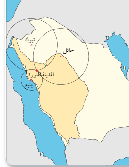
■ الشكل 13-3 لتحديد موقع المركز السطحي للزلازل يحدد العلماء مواقع محطات الرصد على خريطة، ويرسمون حول كل محطة دائرة مركزها المحطة ونصف قطرها بُعد المركز السطحي عن المحطة، وتتقاطع الدوائر جميعها في نقطة تمثل المركز السطحي للزلازل. حدد من الشكل المرفق موقع المركز السطحي للزلازل.
