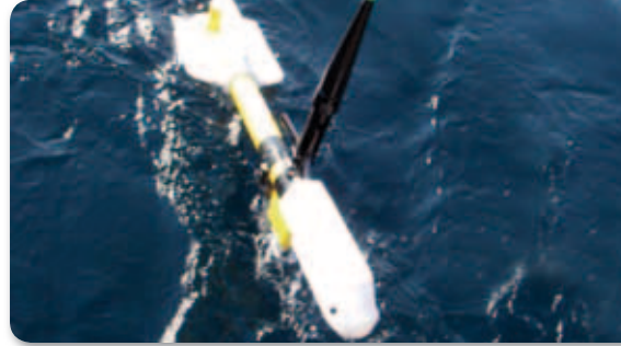
الشكل 7-1 يُستعمل جهاز قياس المغناطيسية للكشف عن التغيرات الطفيفة في المجالات المغناطيسية. وقد عززت البيانات التي تم جمعها باستعمال هذا الجهاز فهم العلماء للصخور الموجودة أسفل قاع المحيط.
