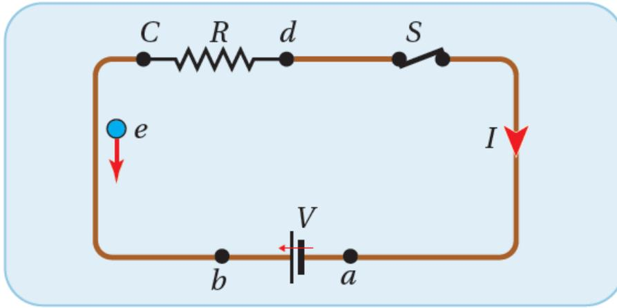
تتحرك الإلكترونات الحرّة في الدارة بعكس اتجاه دروان عقارب الساعة وسريان للتيار الكهربائي باتجاه عقارب الساعة. أما الشحنة الافتراضية الموجبة فهي تتحرك في الدارة باتجاه التيار، أيّ مع اتجاه عقارب الساعة وتكمل حركتها داخل البطارية من القطب السالب إلى القطب الموجب (من a إلى b). وتحصل على الطاقة من الشغل الذي تبذله عليها القوة الدافعة للبطارية.
