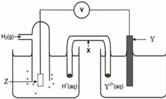
الشكل الآتي يمثل خلية جلفانية في الظروف المعيارية، فإذا علمت أن القطب (Y) تزداد كتلته عند مرور التيار الكهربائي في الأسلاك، وأن قراءة الفولتميتر  $= 0.70V$ ، أجب عن الأسئلة التي تحاذي الشكل:
