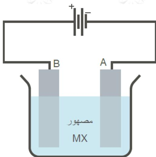
4- أدرس الشكل المجاور، الذي يمثل خلية تحليل كهربائي لمصهور المركب الأيوني MX باستخدام أقطاب من الجرافيت أعطيت الرموز A و B ، ثم أجب عن الأسئلة الآتية:
