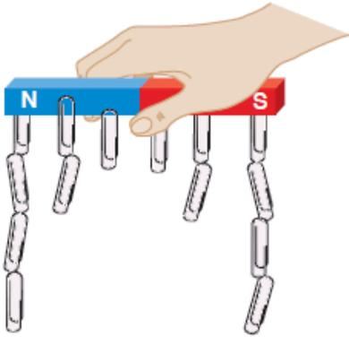
**أستنتج:** يمسك فارس مغناطيساً مستقيماً، ويضع أسفله مشابك ورق. والشكل المجاور يبين المشابك التي انجذبت إلى أجزاء المغناطيس. أصوغ تعميماً معتمداً على الشكل عن قوة المغناطيس.
