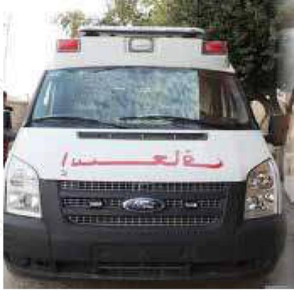
لأن السائق يستخدم المرآة المستوية لرؤية ما خلفه، فتتكون للعبارة المكتوبة صورة في المرآة مقلوبة جانبياً؛ لذا، تكون الصورة مكتوبة بشكل معتدل.
