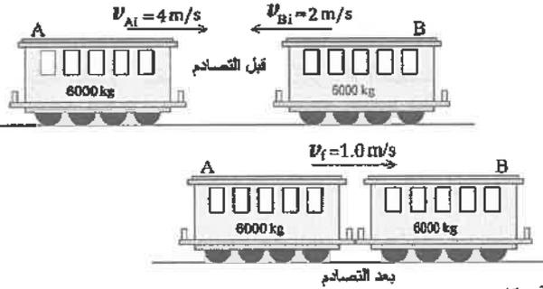
❖ يوضَّح الشكل المجاور عرنيّ قطار (A) و (B)، كُتلة كلٍّ منهما (6000 kg)، إذا تحركت العربة (A) في مسارٍ أفقيٍ مستقيم لسكة حديد بسرعة مقدارها (4 m/s) باتجاه محور  $+x$ ، واصطدمت بالعربة (B) التي تتحرك بسرعة (2 m/s) باتجاه محور  $-x$  على المسار نفسه، فالتحتمًا معًا، وتحركتا بسرعة مقدارها (1.0 m/s) باتجاه  $+x$ . أجب عن الفقرتين (7، 8) الآتيتين:
