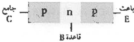
38- يوضح الشكل المجاور طبقات ترانزستور ثنائي القطبية. اعتمادًا على بيانات الشكل، فإن اتجاه التيار الاصطلاحي الموجب يكون من:
