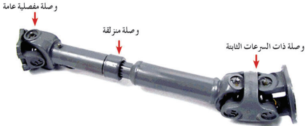
الشكل (3-43): عمود جر يتكون من جزأين متصلين بوصلة منزلقة.
