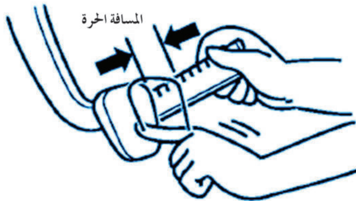
الشكل (4): فحص فاضي دواسة القابض (المسافة الحرة).
