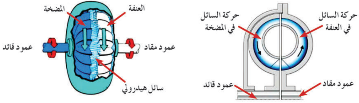
الشكل (3-10): القوابض الهيدرولية.
