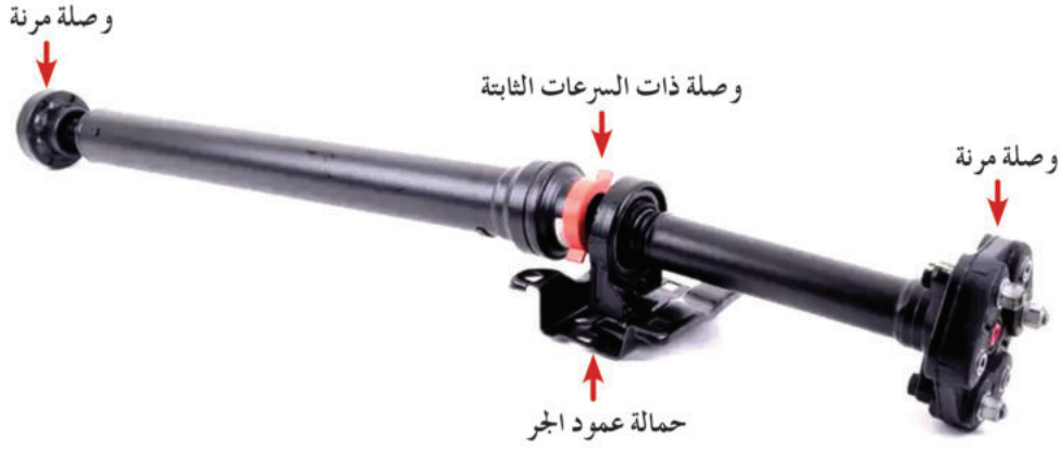
الشكل (3-42): عمود جر يتكون من جزأين بينهما وصلة مفصلية ذات السرعة الثابتة.
