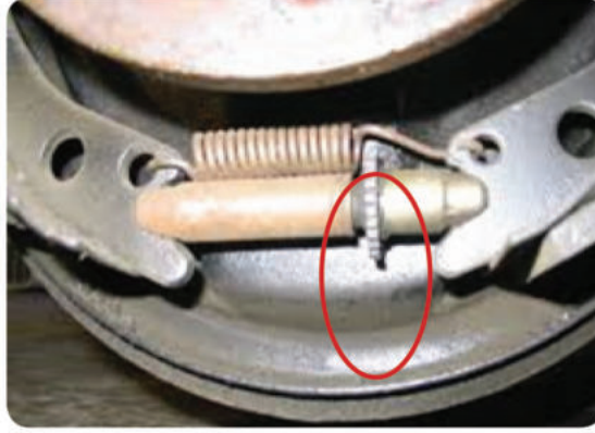
الشكل (2-28): المسنن المرتبط بصمولة المعاييرة.
