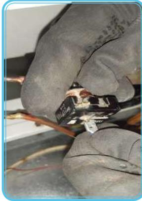
توصيل الأسلاك الكهربائية لمرحل التيار وتثبيتته على جسم الضاغظ.
