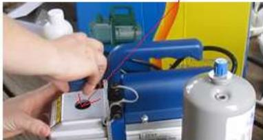
3 تأكد من وجود زيت كافٍ داخل مضخة التفريغ قبل تشغيلها، وإذا نقص الزيت، فأضف كمية مناسبة من الزيت الخاص بمضخة التفريغ (الفاكيوم)، على أن يكون مستوى الزيت أعلى من علامة (MIN)، وأقل من علامة (MAX) الظاهرة على زجاجة رؤية زيت مضخة التفريغ (الفاكيوم) المبينة في الشكل المجاور.
