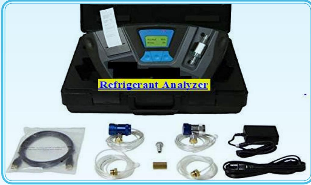
الشكل (5-12): جهاز فحص وسائط التبريد.
