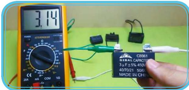
جهاز قياس السعة لفحص المكثفات
