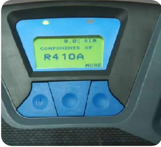
6 افتح صمام أسطوانة وسيط التبريد، ولاحظ قراءة الجهاز التي تشير إلى نسب مكونات وسيط التبريد ونوعه.
