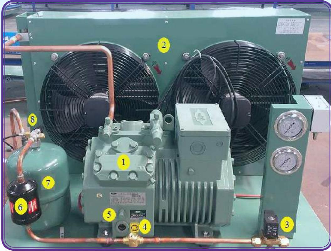
الشكل (24-7): بعض عناصر دورة التبريد الميكانيكية وملحقاتها.
