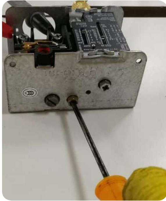
3 لف برغي معايرة ضغط التشغيل باتجاه عقارب الساعة لزيادة قيمة الضغط المطلوبة، وعكس عقارب الساعة لتقليل قيمة الضغط المطلوبة، فمثلاً: حدد قيمة 50 PSI لضغط التشغيل.
