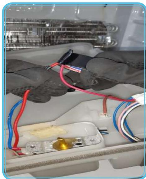
توصيل الأسلاك الكهربائية إلى منظم درجات الحرارة (ثيرموستات).
