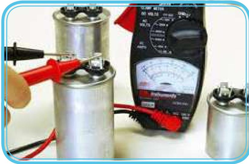
فحص المكثف الكهربائي بجهاز الأومميتر.
