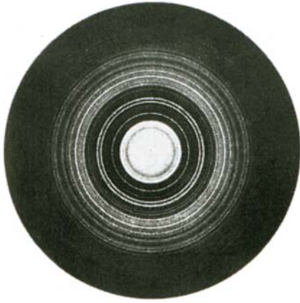
الشكل ( ٧ - ١٢ ) : نمط من حيود الإلكترونات المنتزعة من لفافة ألومنيوم ، كما تظهر مصورة على فيلم حساس.
