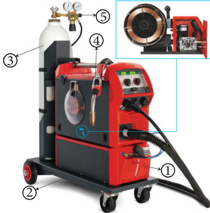
الشكل (2-2): أجزاء محطة اللحام بالقوس الكهربائي المعدني (ميج).
