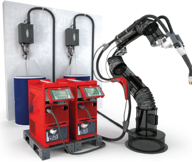
الشكل (2-12): إحدى أنواع الآلات الأوتوماتيكية، المستعملة في عمليات اللحام.
