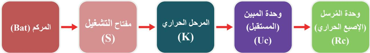
الشكل (5-11): المخطط الصندوقي لمبين درجة حرارة المحرك ذي الملف الحراري.
