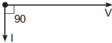
الشكل (1-78): العلاقة بين الفولتية والتيار الملف بالمتجهات.
