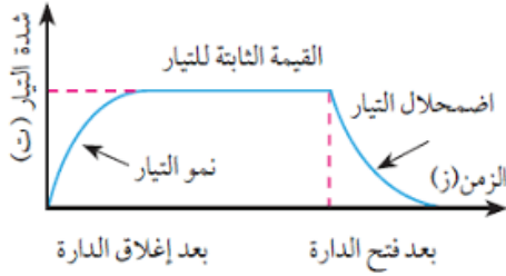
الشكل (1-68): نمو التيار وتلاشيه في المحث.
