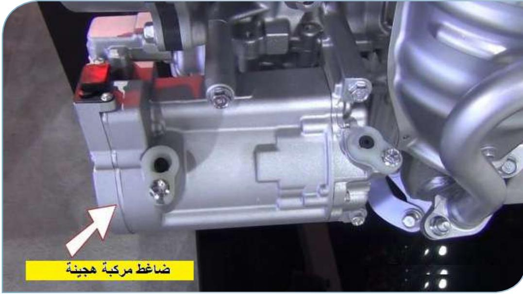
الشكل (6-7): ضاغط نظام التكييف للمركبات الكهربائية والهجينة.
