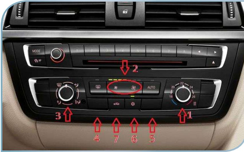
الشكل (7-27): مفاتيح التحكم في نظام تكييف هواء المركبة.
