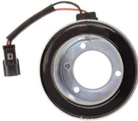
الشكل (7-31): الملف الكهرومغناطيسي لقرص التعشيق.
