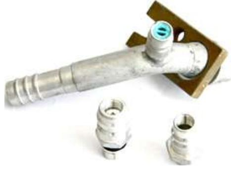
الشكل (7-21): مخرج شحن وسيط التبريد (R134 a).
