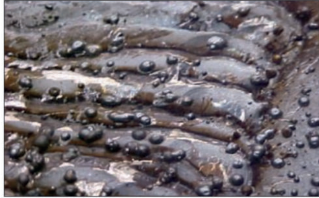
الشكل (1): عيب اللحام المُسمى الرذاذ (الطرطشة).
