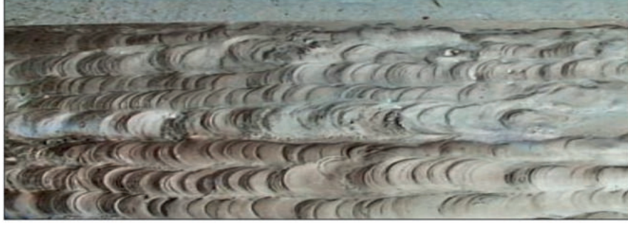
الشكل (3): عيب اللحام المُسمّى خطّ لحام خشن وغير منتظم.
