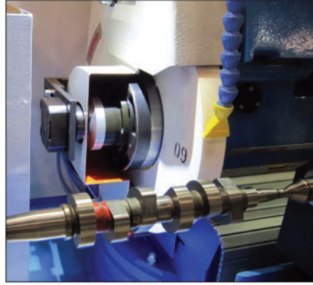
الشكل (8): جهاز الاتزان الديناميكي لحجر الجlx.
