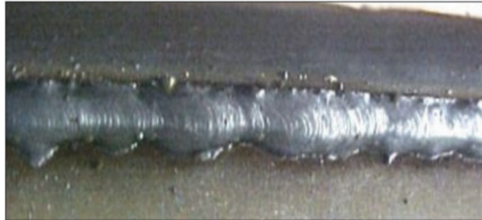
الشكل (5): عيب اللحام المُسمّى الانصهار القليل.
