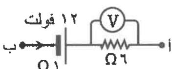
٢١- معتمداً على بيانات الشكل المجاور الذي يبين جزءاً من دارة كهربائية، وإذا علمت أن جهد النقطة (ب) يزيد على جهد النقطة (أ) بمقدار (٩) فولت، فإن قراءة الفولتميتر بوحدة فولت تساوي:
