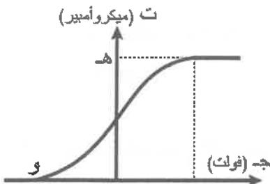
٣٨- يبيّن الشكل تمثيلاً بيانياً للعلاقة بين فرق الجهد ( $\Delta V$ ) في خلية كهروضوئية والتيار الكهروضوئي ( $I$ ) عند سقوط ضوء تردد  $(\nu)$  على مهبط الخلية.
