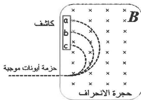
21- يبين الشكل المجاور تحليل عينة مجهرولة باستخدام جهاز مطياف الكلمة. اعتماداً على الشكل فإن انحراف الأيونات (a, b, c) يختلف بسبب اختلافها في:
