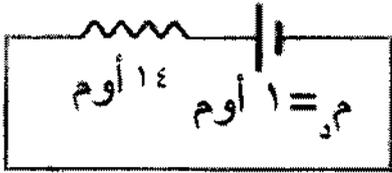
٢٤- يُمثل الشكل المجاور دائرة كهربائية، معتمدًا على البيانات المثبتة في الشكل. القدرة الكهربائية التي تنتجها البطارية (ق.د) بالواط تساوي:
