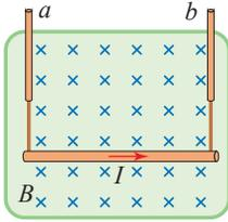
11. موصل للكهرباء مستقيم الشكل طوله (0.45 m) وكتلته (60 g)، في وضع أفقي مُعلّق بواسطة سلكين رأسيين (a, b) ينقلان له تيارًا كهربائيًا مقداره (5 A). حيث (g = 9.8 m/s<sup>2</sup>).
