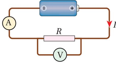
وتُعرّف المقاومة الكهربائية للموصل بأنها نسبة فرق الجهد بين طرفيه إلى التيار الكهربائي المارّ فيه. تقاس المقاومة الكهربائية بوحدة **أوم (ohm)**، ويُستخدم لتمثيلها الرمز (omega:  $\Omega$ ). يمكن تعريف الأوم بأنه؛ مقاومة موصل يسري فيه تيار كهربائي (1 A) عندما يكون فرق الجهد بين طرفيه (1 V).
