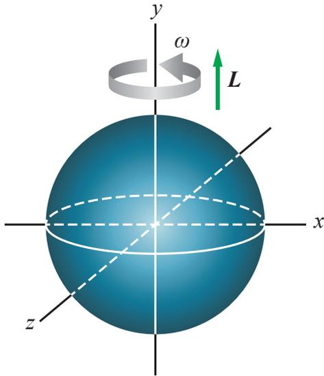
كرة مُصمّنة منتظمة متماثلة كتلتها (5.0 kg) ونصف قطرها (10.0 cm)، تتحرك حركة دورانية حول محور ثابت (محور  $y$ ) يمرُّ في مركزها، بسرعة زاوية ثابتة مقدارها (20 rad/s) بعكس اتجاه حركة عقارب الساعة عند النظر إليها من أعلى، كما هو موضح في الشكل (26). أحسب مقدار الزخم الزاوي للكرة حول هذا المحور، وأحدّد اتجاهه.
