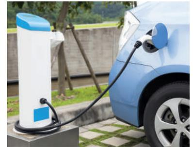
الشكل (12): شحن السيارة الكهربائية من جهاز شحن عام.
