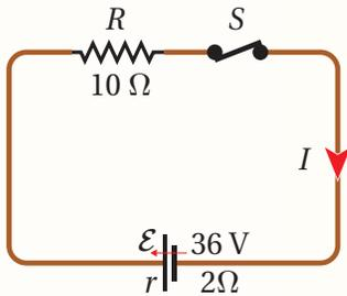
3. **أستخدم المتغيرات:** في الدارة الكهربائية المبيّنة في الشكل المجاور؛ أعلّق المفتاح (s) مدة (5 min). إذا كان التيار (3 A)؛ أحسب ما يأتي:
