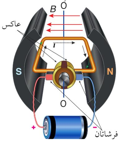
الشكل (18): أجزاء المحرك الكهربائي الرئيسة.
