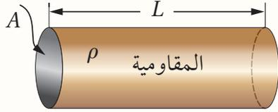
2. يبيِّن الشكل المجاور موصلًا فلزيًا طوله  $(L)$  ومساحة مَقطعِه  $(A)$ . أوضِّح متى تتساوى مقاومة هذا الموصل مع مقاومية المادة المصنوع منها.
