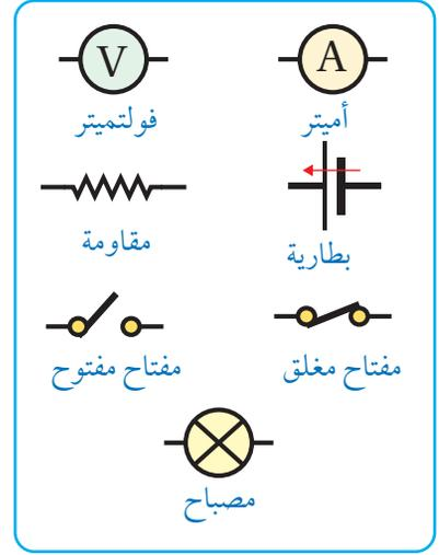
الشكل (13): بعض رموز عناصر الدارة الكهربائية البسيطة.
