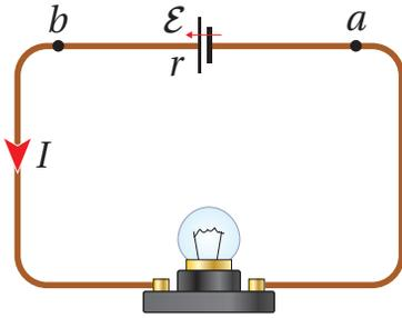
بطارية قوتها الدافعة الكهربائية (12.0 V) ومقاومتها الداخلية ( $0.5 \Omega$ )، وُصِل قطباها مع مصباح في دائرة كهربائية، كما في الشكل (8)، فكان التيار المار فيها ( $2.4 \text{ A}$ ). أحسب فرق الجهد بين قطبي البطارية.  $\Delta V_\epsilon = V_b - V_a$ .
