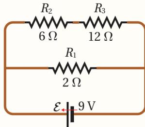
3. **أستخدم المتغيرات:** يبيّن الشكل المجاور دائرة كهربائية تحتوي بطاريةً ومقاومات، معتمدًا على بيانات الشكل وبإهمال المقاومة الداخلية؛ أحسب المقاومة المكافئة للدائرة، ثمّ مقدار التيار فيها.
