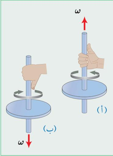
الشكل (19): استخدام قاعدة قبضة اليد اليمنى لتحديد اتجاه السرعة الزاوية لجسم يدور (أ) بعكس اتجاه حركة عقارب الساعة، (ب) وجسم يدور باتجاه حركة عقارب الساعة، عند النظر إليهما من أعلى.
