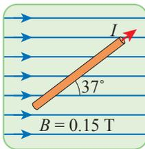
9. موصلٌ مستقيمٌ يحمل تيارًا كهربائيًا  $(8 \text{ A})$  داخل مجالٍ مغناطيسيٍّ منتظمٍ كما في الشكل المجاور. أحسب مقدار القوة المغناطيسيّة التي يؤثر بها المجال المغناطيسيّ في وحدة الأطوال من الموصل، وأحدد اتجاهها.
