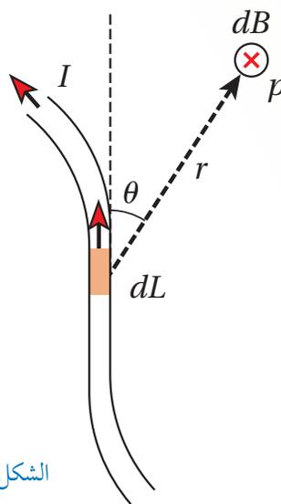
الشكل (19): المجال المغناطيسيّ الجزئيّ الناتج عن قطعة صغيرة من موصلٍ يحمل تيارًا كهربائيًا.
