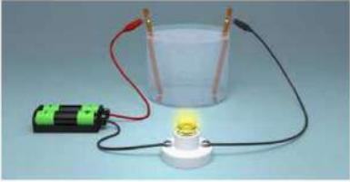
الشكل (7): المحاليل الموصلة في الدارات الكهربائية.
