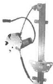
٥- يبيّن الشكل المجاور أحد مكونات نظام فتح النوافذ الكهربائية وإغلاقها في المركبة وبدل الرقم (١) على:
