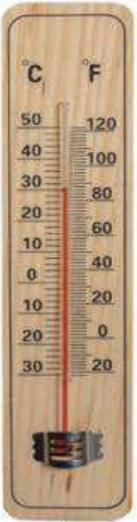
الشكل (4) مقياس درجة الحرارة الكحولي.
