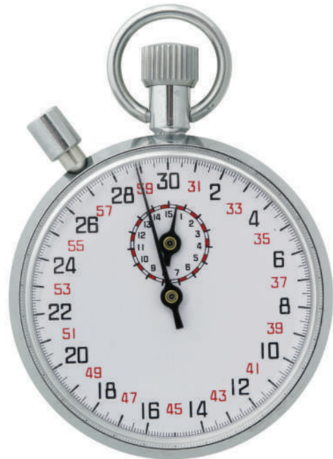
الصورة ١-٢ يمكن لساعة الإيقاف التناظرية هذه قياس الفترات الزمنية التي تتراوح بين 0.1 ثانية و 15 دقيقة
