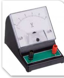
الشكل (9): الفولتميتر جهاز يستخدم لقياس فرق الجهد.
