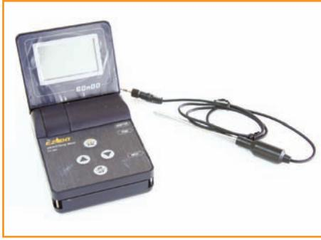
الشكل (١-٥): جهاز قياس الرقم الهيدروجيني.
