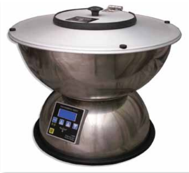
الشكل (٢-٨): جهاز طرد مركزي.
