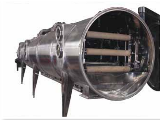
الشكل (١٦-٢): التبخير تحت التفريغ.
