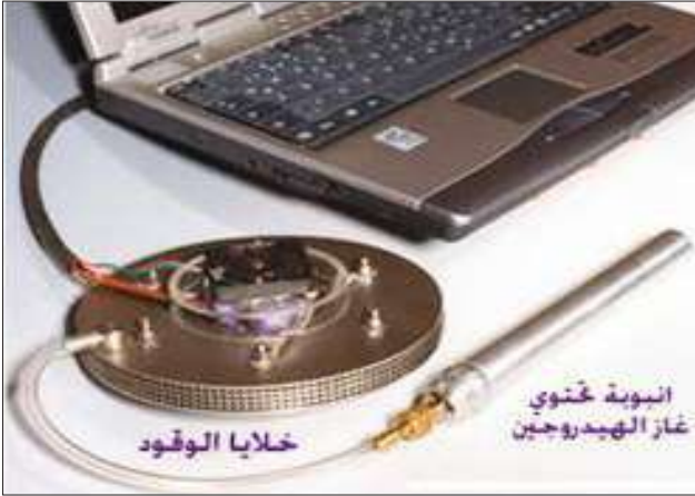
شكل (13) جهاز كمبيوتر دفتري يحصل على الطاقة الكهربائية من بطارية وقود الهيدروجين
