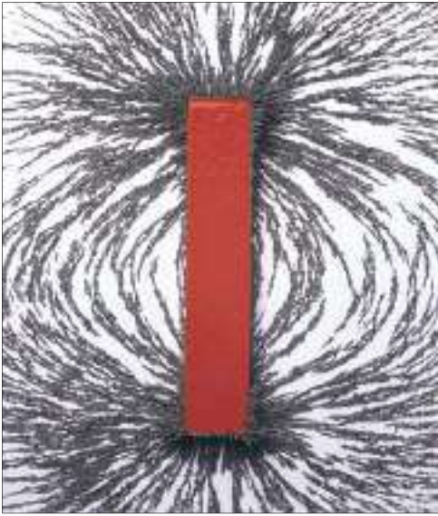
الشكل (17) خطوط المجال المغناطيسي كما تبينه برادة الحديد حول ساق مغناطيسية.
