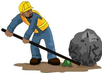
في الشكل المجاور يؤثر العامل بقوة على القطعة الحديدية لتحريك الصخرة. تُمثل قوة العامل في هذا النظام: القوة. وتُمثل الساق الحديدية: الساق الصلبة (الآلة البسيطة). ويُمثل وزن الصخرة: المقاومة. وتُمثل نقطة التلامس بين الساق والأرض البارزة: نقطة الارتكاز (محور الدوران).
