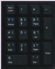
شكل (٤-١٥): لوحة المفاتيح الرقمية
