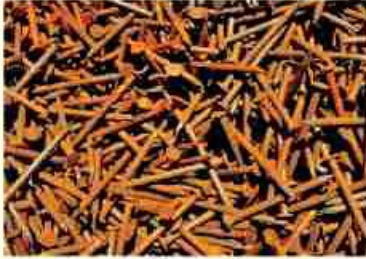
شكل (٣-١١): المسامير يعلوها الصدأ إثر تعرضها للرطوبة.
