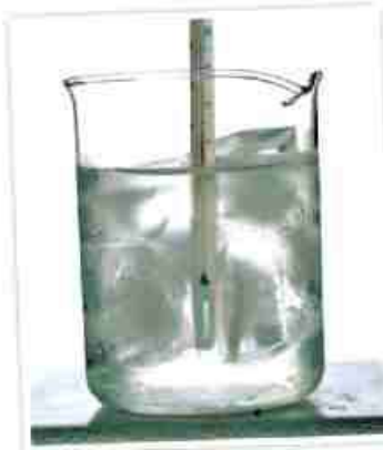
شكل (٢-١٠): الترمومتر المئوى يقيس درجة حرارة الماء.
